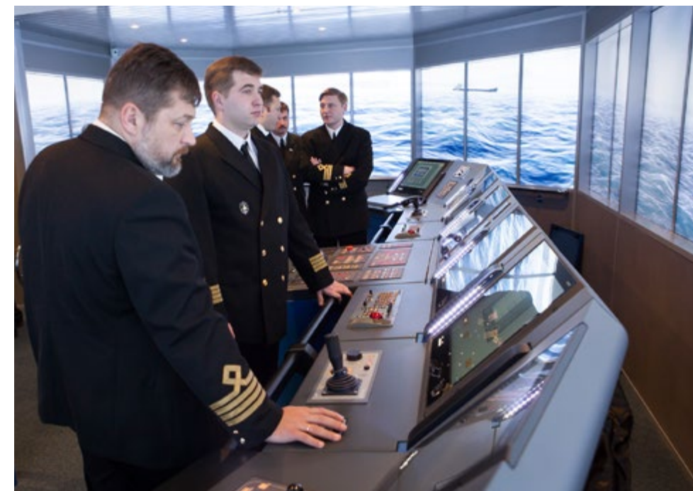
Комплексный навигационный тренажер TRANSAS NTPRO 5000, установленный в тренажерном центре ПАО «Совкомфлот» в Санкт-Петербурге
