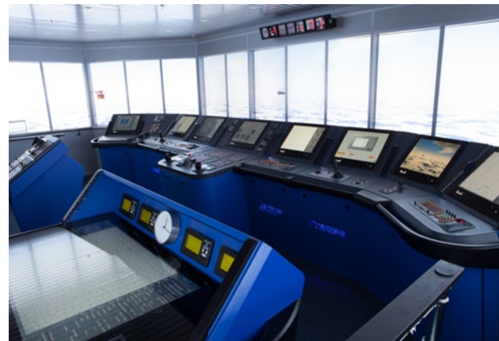
Комплексный навигационный тренажер TRANSAS NTPRO 5000, установленный в тренажерном центре ПАО «Совкомфлот» в Санкт-Петербурге
